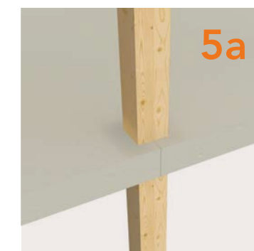
5a Aufstellen der Stützen für das nächste Geschoss
