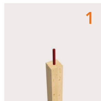
1 Aufstellen der Fassadenstütze, die bereits mit Stahlverbindungskopf geliefert wird.
